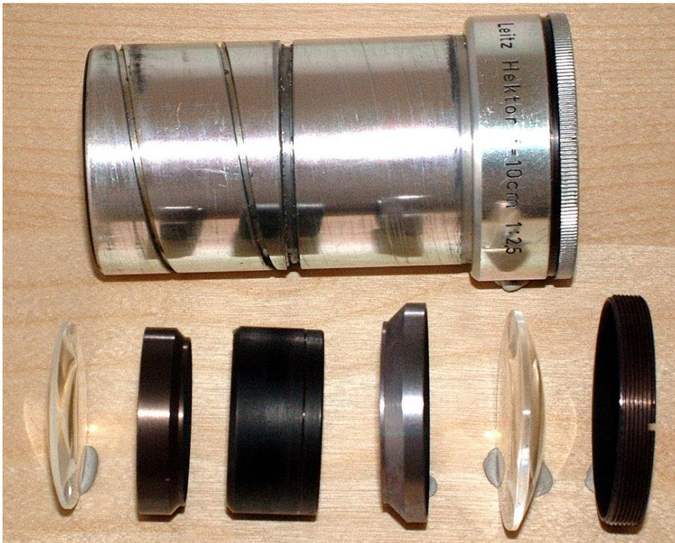
Ich hab es dann rechts und links gekürzt. Rechts ist ganz wichtig, da man so nah als möglich an das Objektiv der Digitalkamera ran muss, um Vignettierung so weit als möglich zu unterbinden. Dann wurde auch eine alte 55er Filterfassung angeklebt. Folgendes Bild zeigt es mit Tubus und ohne
