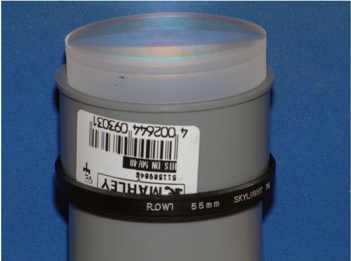
Das alte Filtergewinde zentriert perfekt auf dem PVC-Rohr und sitzt dank des Anschlags schön senkrecht zur Achse und ließe sich so mit Silikon wunderbar fest kleben.
